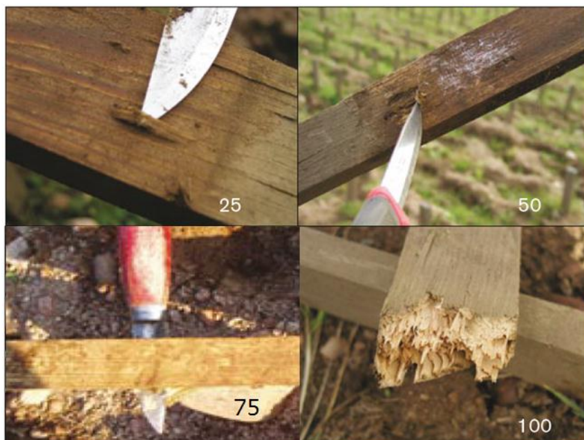
Figur 7 Visualisering av rötindex enligt den europeiska fältprovningsstandarden EN 252 som används för att analysera nedbrytning av trä i markkontakt (Referens: Råberg, Terziev 2006)
