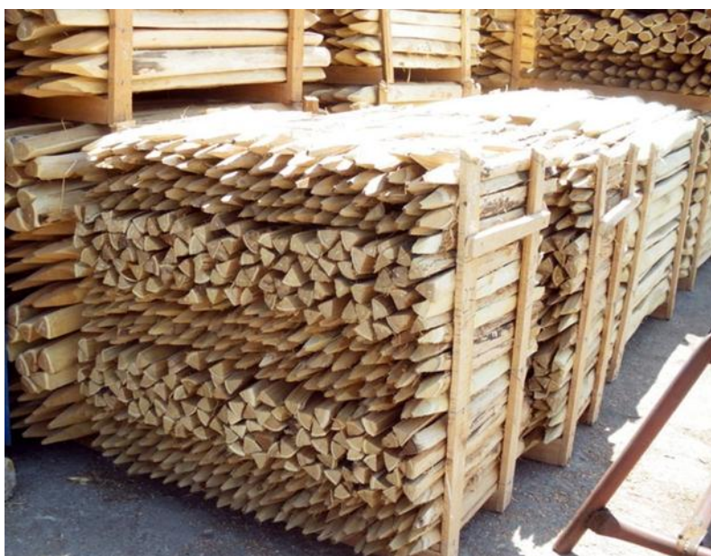
Figur 11 Stolpar av kluvet robinia virke travade för transport till kund. (Referens: Hardy 2013)
